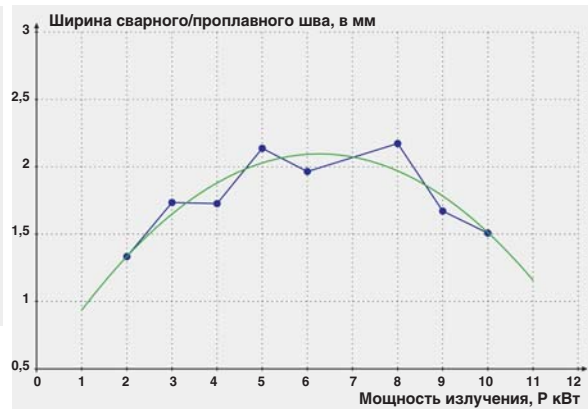
Рис. 8. Зависимость ширины лицевого валика сварного/проплавного шва от мощности излучения. Скорость сварки — 3 м/мин. Фокусировка: - 2 мм.
