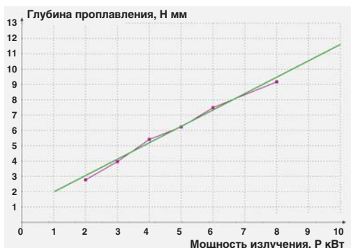
← Рис. 5. Зависимость глубины проплавления H от мощности излучения P. Скорость сварки — 3 м/мин. Фокусировка: — 2 мм
