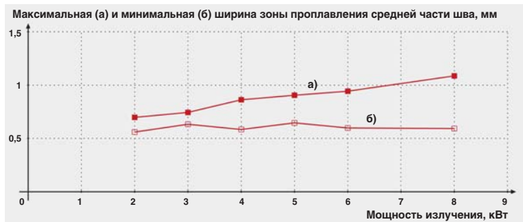
Рис. 7. Зависимость максимальной (а) и минимальной (б) ширины зоны проплавления средней части сварного шва (без сквозного проплавления) от мощности излучения. Скорость сварки - 3 м/мин. Фокусировка: - 2 мм
