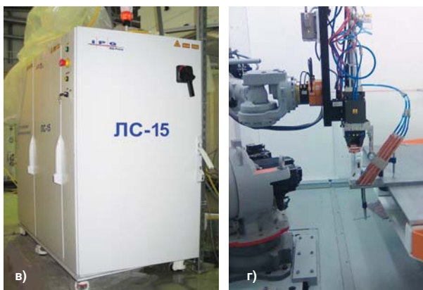
Рис. 1. Лазерный автоматизированный технологический комплекс: а) специалисты, принимавшие участие в монтаже, наладке и запуске, б) технологическая кабина, в) волоконный лазер, г) робот и сварочная головка
