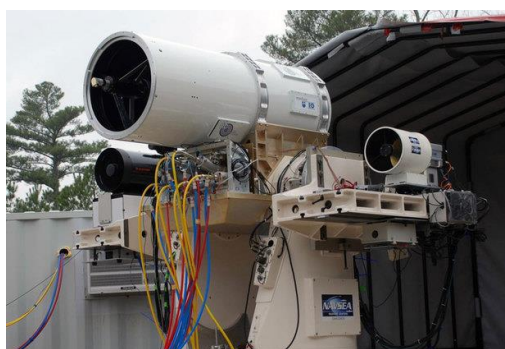
Рис.14. Опытный образец лазерной боевой системы LaWS во время первых испытаний в 2010 года – при наземном базировании [25]
