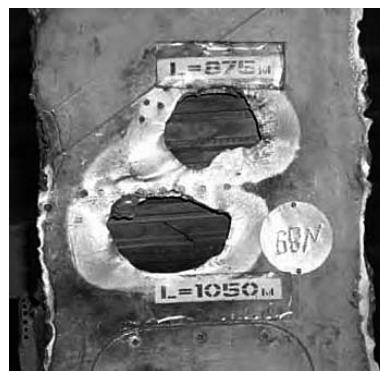
Рис. 4. Примеры воздействия высокоэнергетического \text{CO}_2 -лазера на модель самолета (НПО «Алмаз», 1976 г.) – а, твердотельного лазера на стальной образец толщиной 15 см – б и воздействия лазерного излучения ВЭЛ на элемент обшивки – в [10]
